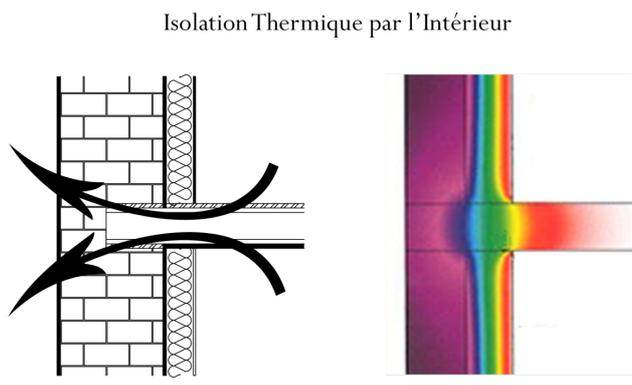
Figure 36 : température interne dans une paroi en Isolation Thermique par l'Intérieur
