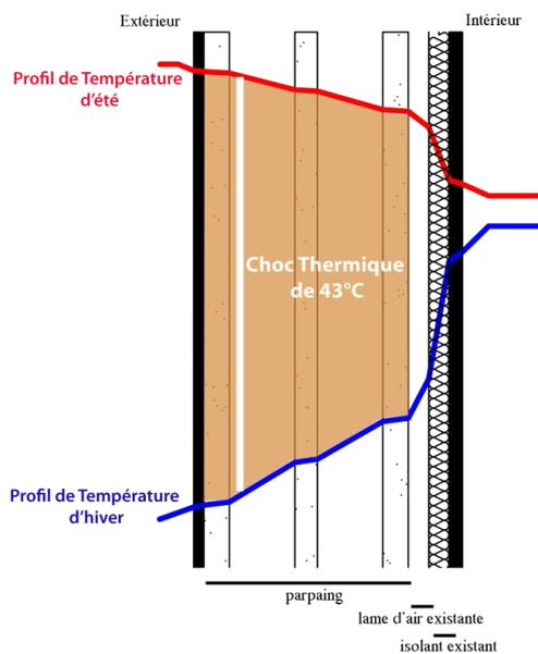
Figure 13 : Choc Thermique avec une paroi en parpaing
