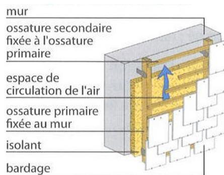
Fig Figure 25 : Bardage à ossature double
