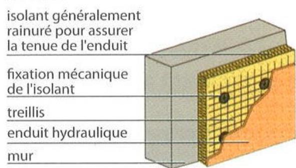
Les systèmes avec enduit mince (Figure 23) se composent d'un isolant fixé sur l'extérieur de la paroi et d'un enduit spécifique armé d'un tissu de fibre de verre et de l'enduit de finition.
