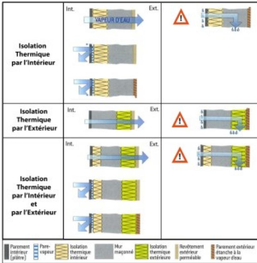
Figure 38 : Risque de condensation en fonction de la composition de la paroi
