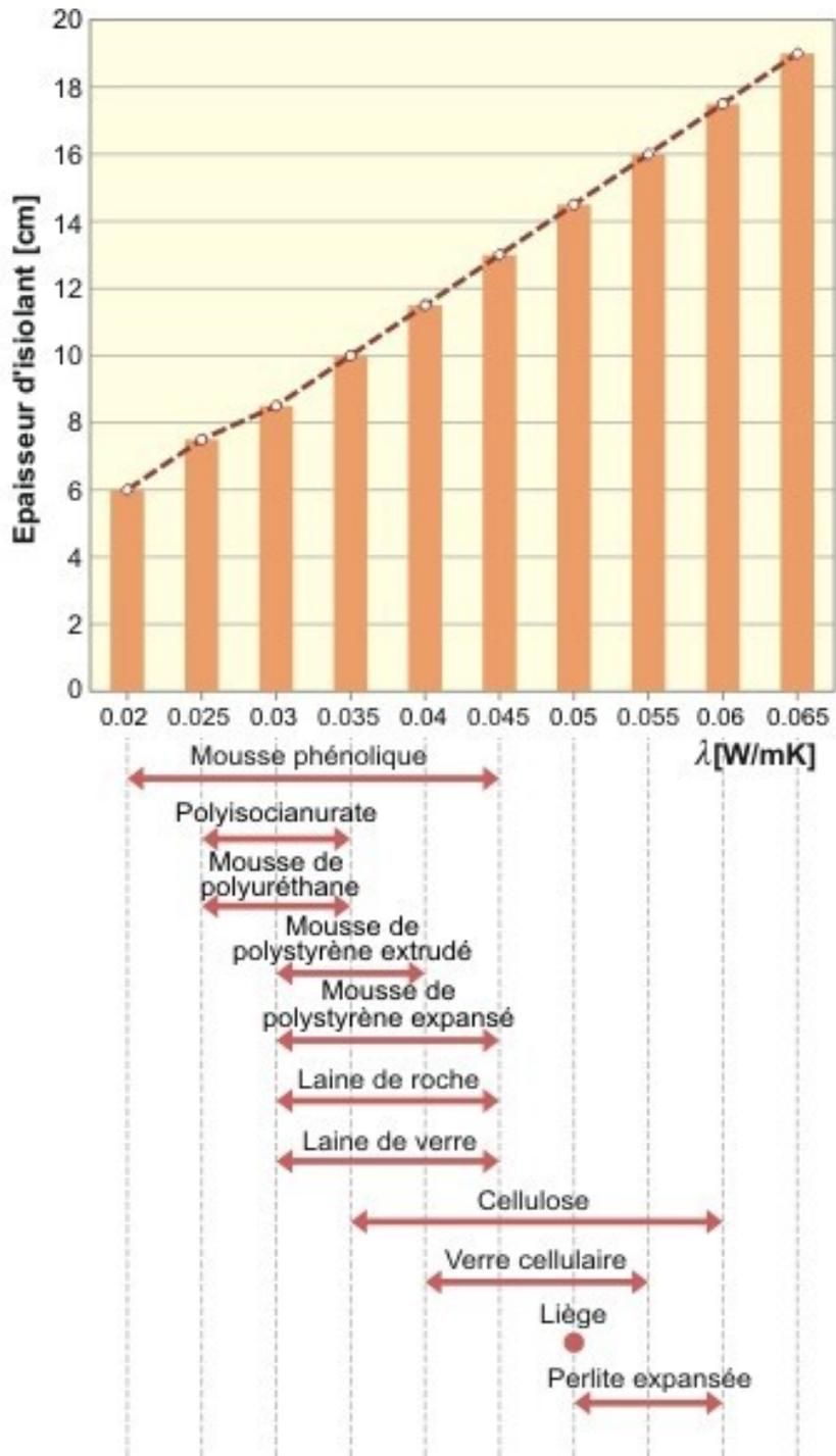
Figure 30 : Conductivité thermique de quelques isolants et leur épaisseur pour atteindre une résistance thermique de 3 m<sup>2</sup>.K/W
