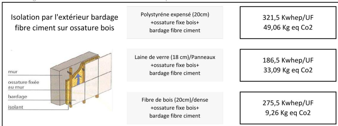
Figure 5 : Coût environnemental de l'isolation par l'extérieur avec bardage fibre ciment sur ossature bois
