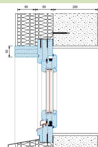
Figure 7 : Fenêtre dans le plan de l'isolation
